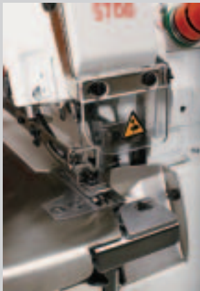
Manuelle Nahtanfangsverriegelung mit Spannungslüftung Manual backlatching with tension release
