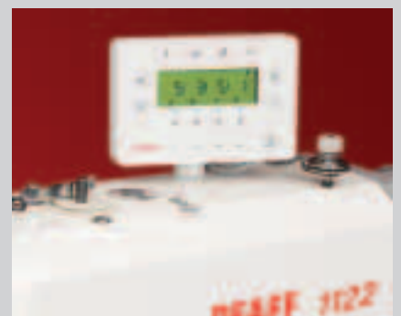
Am neuen Bedienfeld BDF-S1 sind Grundfunktionen wie z.B. Nahtverriegelungen, Nadel- und Nähfußpositionen, Stopprogramme sowie ein Nähprogramm mit gezählten Nähten einfach einzugeben.
